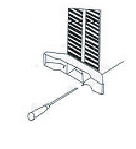
Der kræves to skruer til hver fod. Efter montering af fodderne skal det kontrolleres, at el-radiatoren står sikkert og stabilt.
