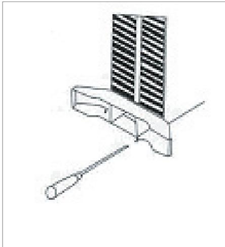
Für jeden Fuß sind zwei Schrauben erforderlich. Nach der Montage der Füße muss kontrolliert werden, ob der Elektroheizkörper sicher und stabil steht.
