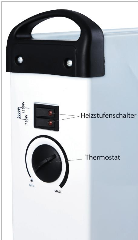
Der Elektroheizkörper verfügt über einen automatischen Unterbrechungsschalter, der im Falle einer Überhitzung ausgelöst wird. Wenn dieser Unterbrechungsschalter ausgelöst wird, müssen Sie beide Heizstufenschalter abschalten und den Stecker aus der Steckdose ziehen. Lassen Sie den Elektroheizkörper danach abkühlen,
