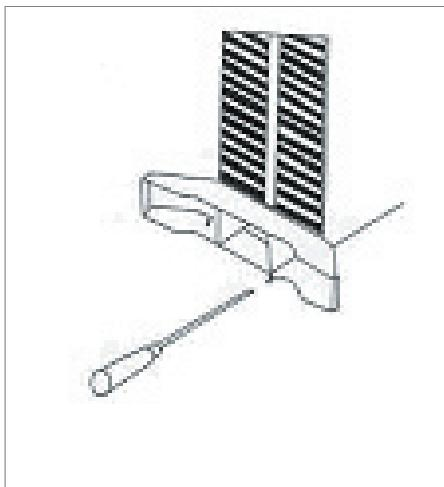
Iga jala jaoks on tarvis kahte kruvi. Kui jalad on kinnitatud, kontrollige, kas elektriradiaator seisab kindlalt ja stabiilselt püsti.
