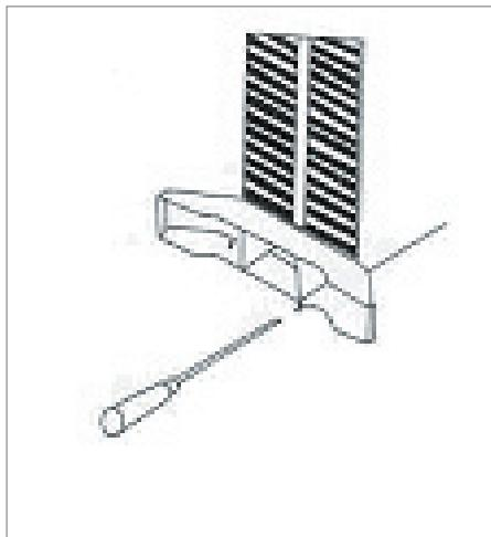
Det behövs två skruvar till varje fot. Efter monteringen av fötterna ska du kontrollera att det elektriska elementet står säkert och stabilt.
