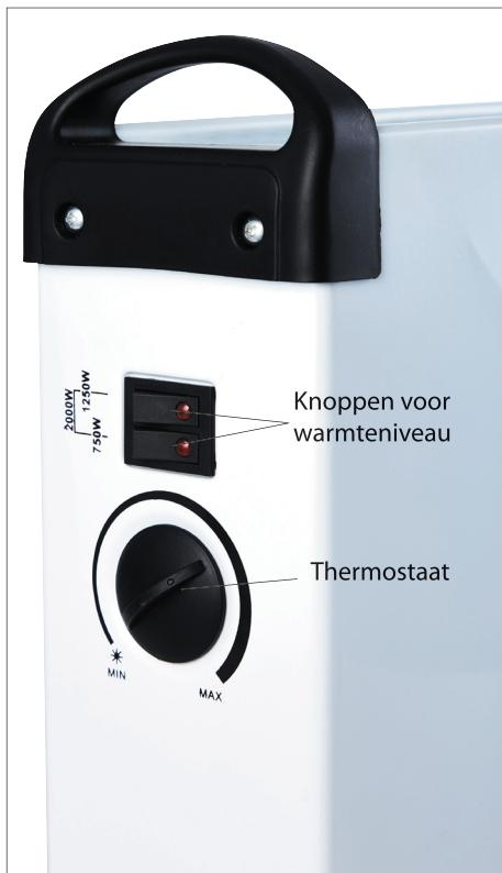
De elektrische radiator is voorzien van een automatische stroomonderbreker die inschakelt in geval van oververhitting. Wanneer deze stroomonderbreker wordt ingeschakeld, zet u beide knoppen voor warmteniveau uit en trekt u de stekker uit het stopcontact. Laat de elektrische radiator afkoelen en verwijder alle zaken die de luchtstroom kunnen blokkeren voordat
