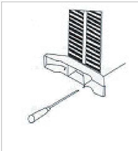
Voor elk voetje zijn twee schroeven nodig. Nadat u de voetjes hebt bevestigd, controleert u of de elektrische radiator stevig en stabiel staat.
