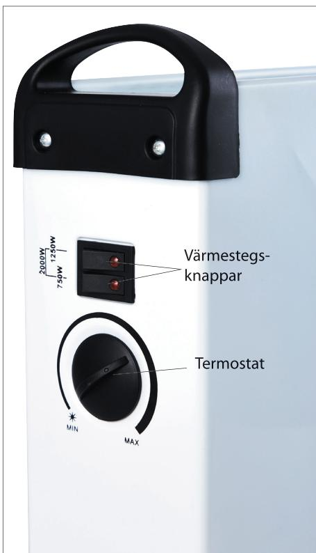
Det elektriska elementet är utrustat med en automatisk strömbrytare som aktiveras vid överhettning. Om denna strömbrytare aktiveras ska du slå av bågge värmestegsknapparna och dra ut kontakten från väggtagget. Låt sedan det elektriska elementet svalna, och ta bort allt som kan blockera luftflödet innan du slår på det elektriska elementet igen. Om den automatiska strömbrytaren aktiveras upprepade gånger bör det elektriska elementet lämnas in för service.
