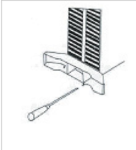
Hver fot trenger to skruer. Når føttene er montert, må du kontrollere at den elektriske varmeovnen står sikkert og stabilt.
