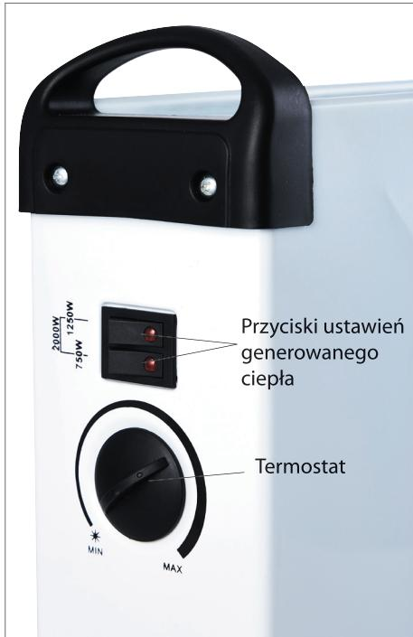
Grzejnik elektryczny jest wyposażony w automatyczny wyłącznik, który zostaje aktywowany w momencie przegrzania. Jeśli aktywuje się ten wyłącznik, należy wyłączyć obydwa przyciski i wyjąć wtyczkę z gniazdka elektrycznego. Następnie pozostawić grzejnik do ostygnięcia i przez ponownym włączeniem grzejnika usunąć wszystkie przedmioty mogące blokować przepływ powietrza. W przypadku częstej aktywacji wyłącznika automatycznego należy oddać grzejnik do serwisu.
