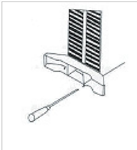
Il faut deux vis pour chaque pied. Une fois les pieds attachés, contrôlez que le radiateur électrique repose bien solidement dessus.
