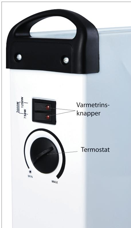
El-radiatoren er forsynet med en automatisk afbryder, der aktiveres i tilfælde af overophedning. Hvis denne afbryder aktiveres, skal du slå begge varmetrinsknapper fra og trække stikket ud af stikkontakten. Lad derefter el-radiatoren køle af, og fjern alt, hvad der måtte blokere en uhindret luftstrøm, før du tænder el-radiatoren igen. Hvis den automatisk afbryder aktiveres gentagne gange, skal el-radiatoren indleveres til service.
