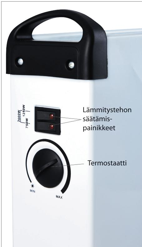
Sähköpatterissa on automaattinen katkaisija, joka laukeaa patterin ylikuumentuessa. Jos se laukeaa, paina molempia lämmitystehon valintapainikkeita ja irrota pistoke pistorasiasta. Anna tämän jälkeen sähköpatterin jäähtyä ja poista mahdollinen ilmanvaihdon tukos, ennen kuin käynnistät sähköpatterin uudelleen. Jos turvakatkaisin laukeaa toistuvasti, vie sähköpatteri huoltoon.
