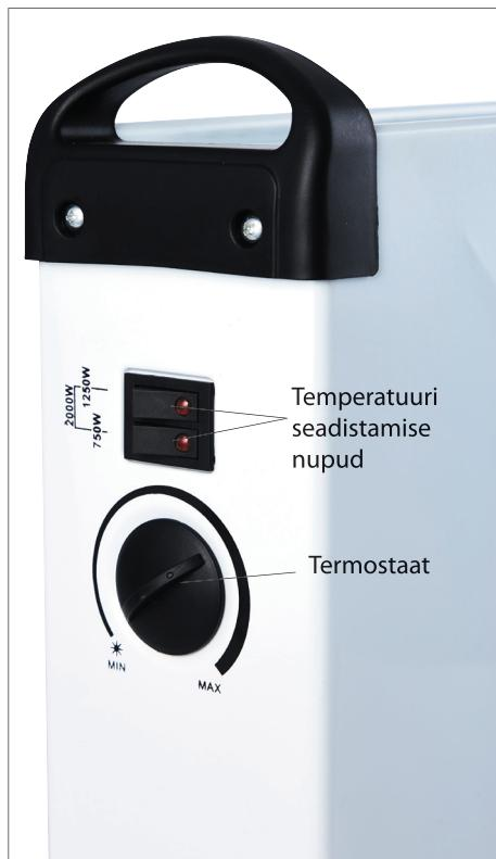
Elektriradiaatoril on automaatne kaitselülit, mis aktiveerub ülekuumenemise korral. Kui kaitselülit aktiveerub, lülitage mölemad temperatuuri seadistamise nupud välja ja eemaldage pistik pistikupesast. Seejärel laske elektriradiaatoril enne selle uuesti sisselülitamist jahtuda ja eemaldage kõik, mis võib õhuvoolu takistada. Kui automaatne kaitselülit aktiveerub korduvalt, tuleb elektriradiaator teenindusse viia.
